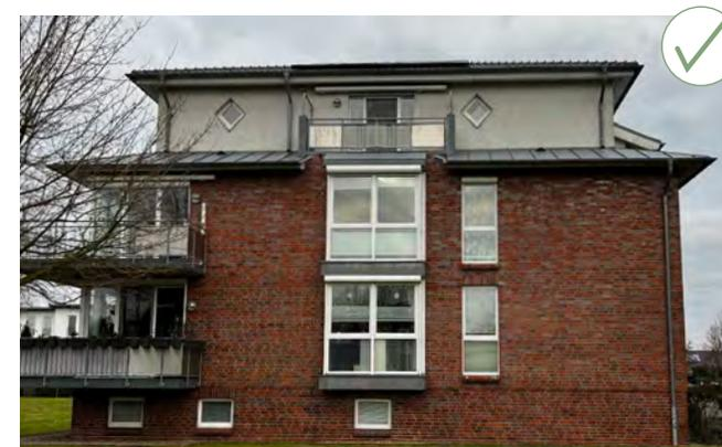
Abweichende Fassadenverkleidung in max. 30 % der umlaufenden Fassadenfläche (Putz)
